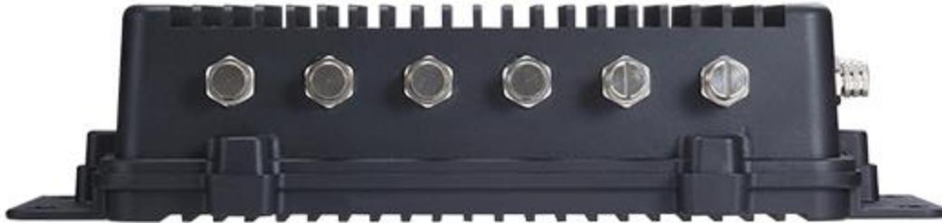
*L'eBOX800-841FL è un sistema embedded fanless con grado di protezione IP67, progettato per il funzionamento a temperature da -30 °C a +60 °C, con possibilità di montaggio a parete.*
